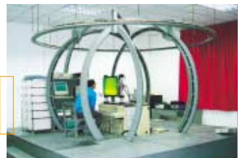
Test de sensibilité d'un tube de téléviseur au champ magnétique terrestre à Foshan (Chine).
